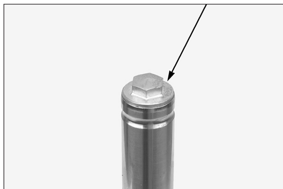
PARAFUSO SUPERIOR DO GARFO/ANEL DE VEDAÇÃO
